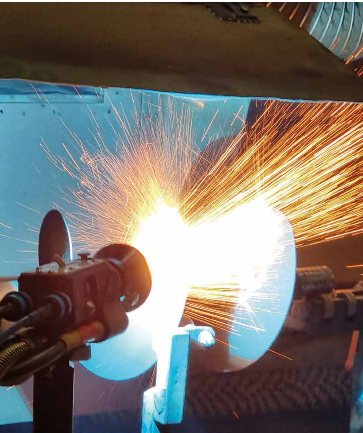
Rivestimento duro di una filettatura a vite mediante un deposito di ghisa ad alto contenuto di cromo.
