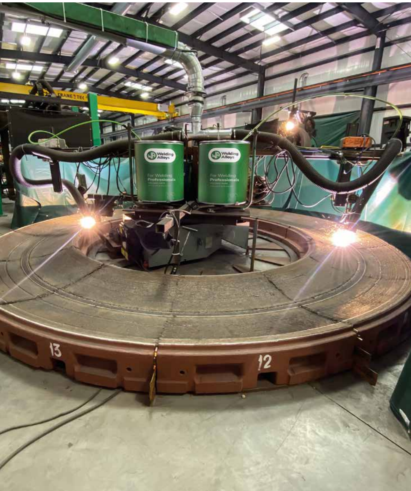
Riparto duro su pista mulino e rulli con deposito in ghisa austenitica ad alto Cr.
