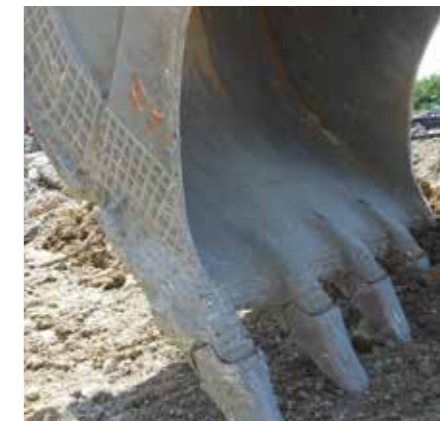
Minerario: riporti benne di scavatori
