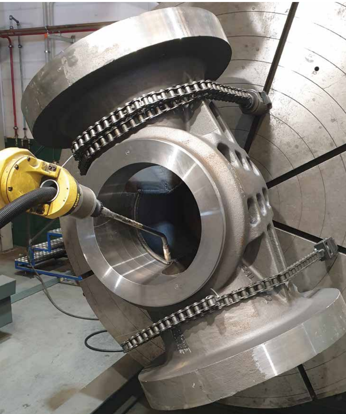
Placcatura automatizzata con STELLOY 21-G.
