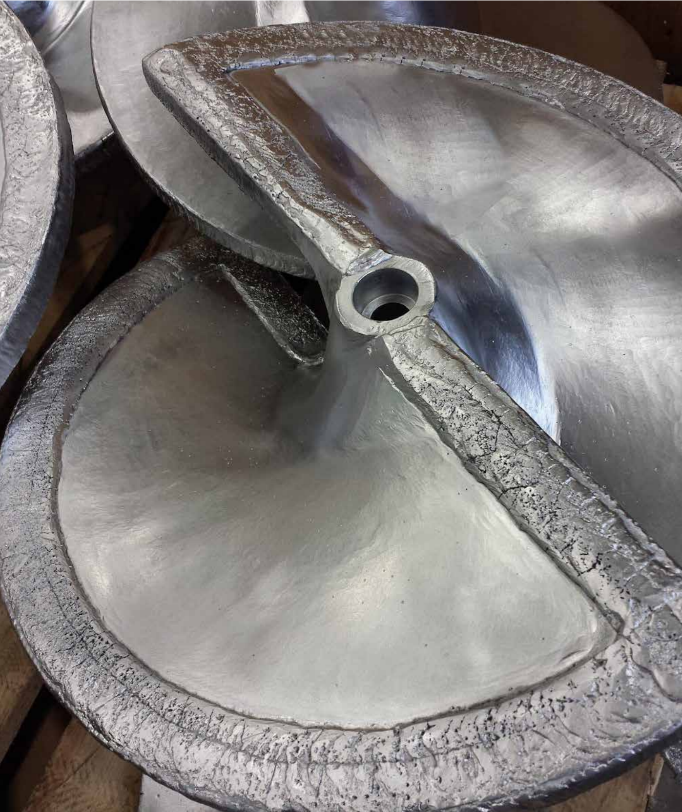
Recargue de un transportador sinfín mediante HARDFACE STAINCARBW.
