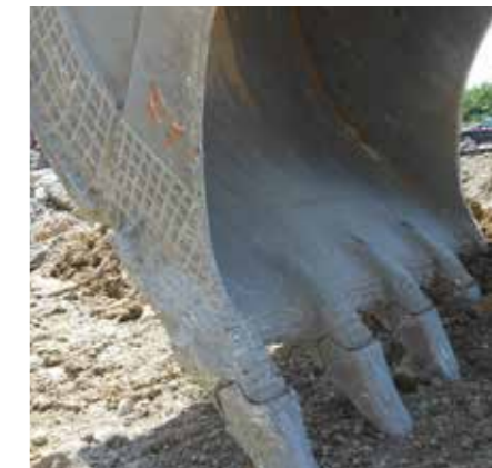
Minería: recargue duro de cuchara excavadora
