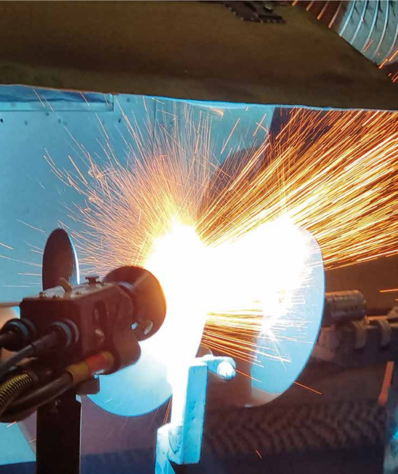
Recargue duro de un tornillo con un depósito de hierro fundido con alto contenido en cromo.
