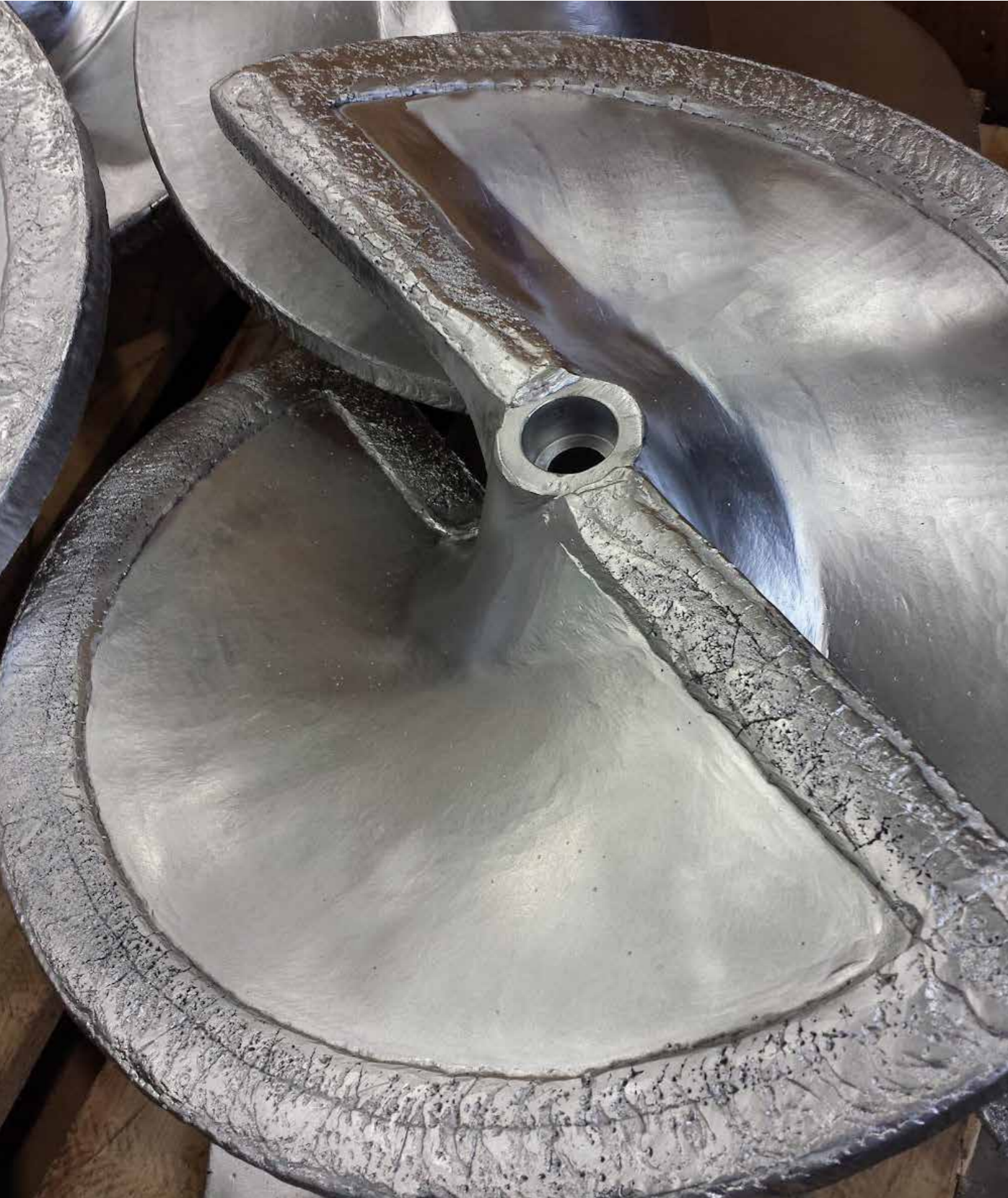
Hartauftragung an einer Förderschnecke mit HARDFACE STAINCARBW.
