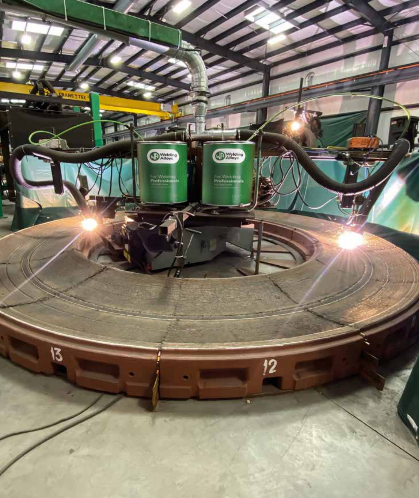
Hartauftragung an einer Mahlbahn und einer Mahlwalze (im Hintergrund) aus der Zementindustrie mit einer Chrom-Karbid-Legierung.
