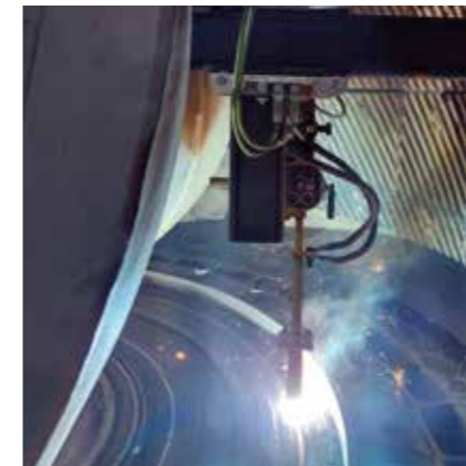
Zement: Aufpanzerung einer Mahlbahn
