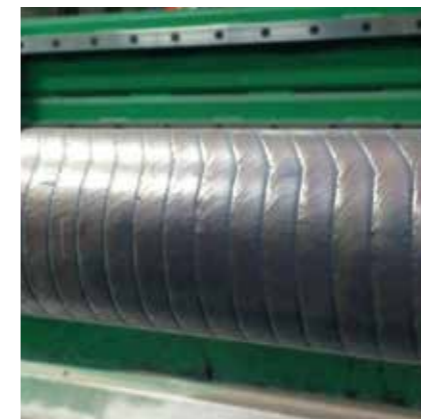
Stahl: Stranggusswalze aufgeschweißt
