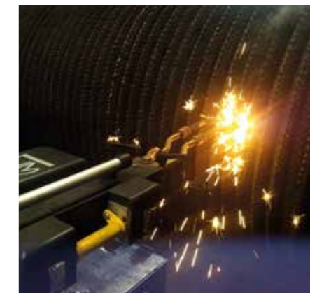
Zucker: Aufpanzerung einer Presswalze
